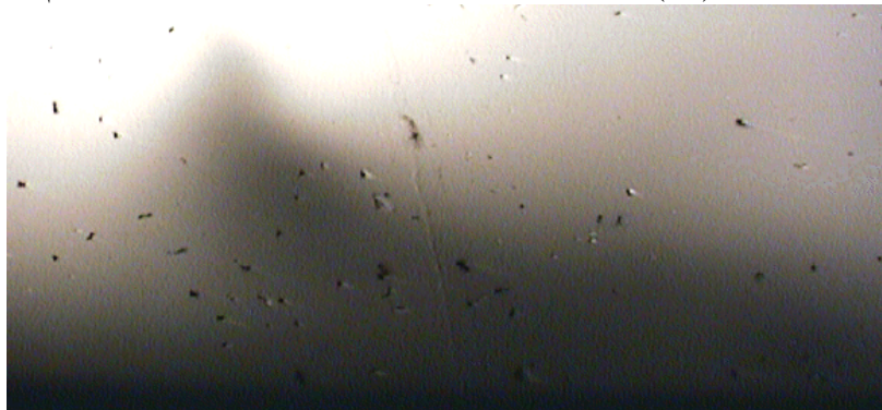
شکل (۱۲) ذرات نقره احیا شده که در اثر فشار از جای خود بر روی فیلم کنده شده اند
