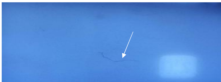
شکل (۱۸) چسبیدگی مو بر روی پرتونگاشت
