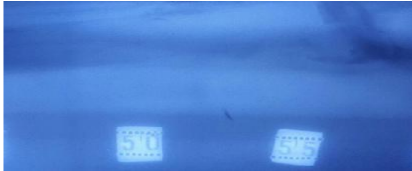
شکل (۰۴) اثر لکه محلول ظهور در اثر آلودگی دست اپراتور به محلول ظهور موقع به دست گرفتن فیلم
