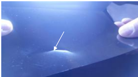
شکل (۰۹) شکستگی فیلم در اثر هندسه پرتونگاری
