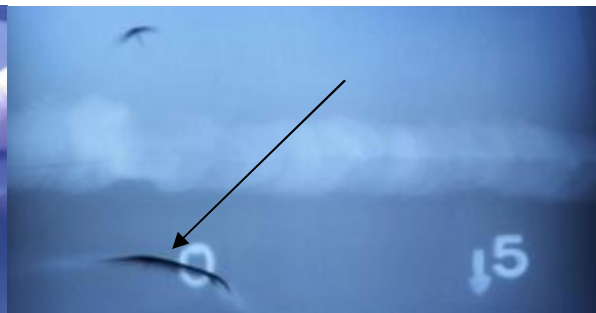
شکل (۰۹) تصویر اثر شکستگی فیلم بر روی پرتونگاشت
