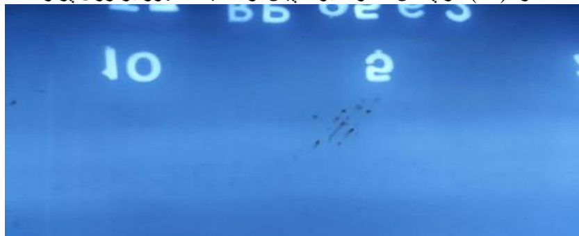
شکل شماره (03) اثر پاشش محلول ظهور پیش از عملیات ظهور بر روی پرتونگاشت
